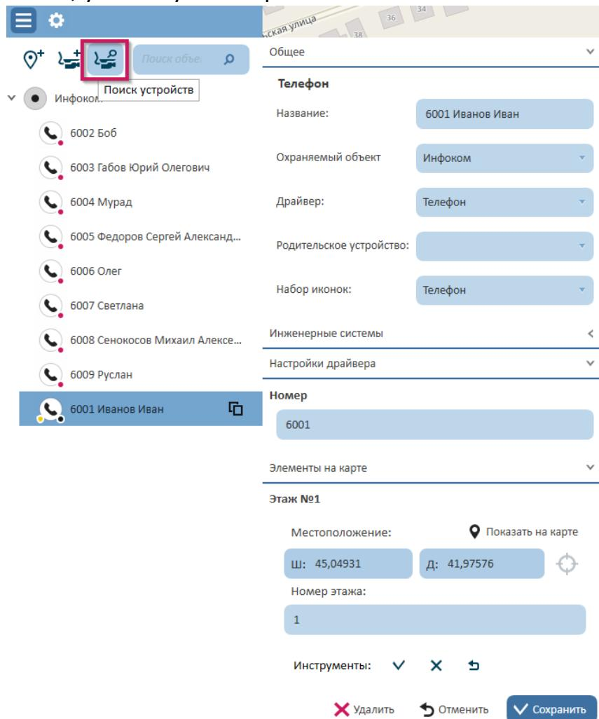
Рисунок 89 – Кнопка запуска Мастера поиска устройств
