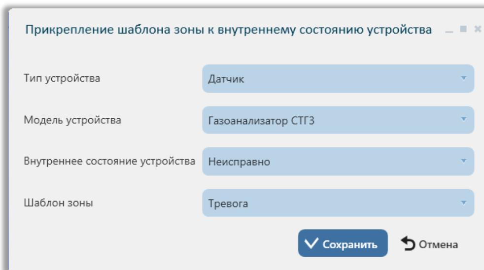
Рисунок 27 – Прикрепление шаблона зоны к внутреннему состоянию устройства
