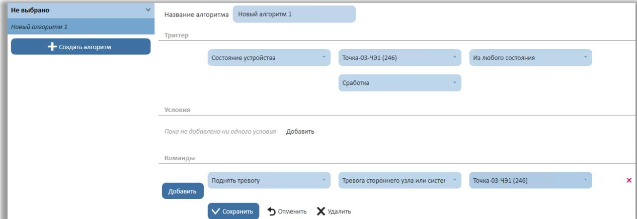
**Рисунок 104 – Пример алгоритма по автоматическому запуску тревоги**
