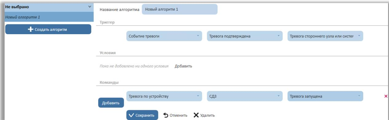
**Рисунок 108 – Создание алгоритма для изменения цвета иконки датчика, ставшего причиной тревоги, при условии, что тревога была подтверждена оператором**
