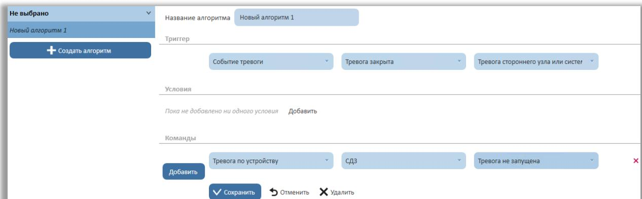
**Рисунок 110 – Создание алгоритма для изменения цвета иконки датчика, ставшего причиной тревоги, при условии, что тревога была закрыта оператором или отмечена как ложная**
